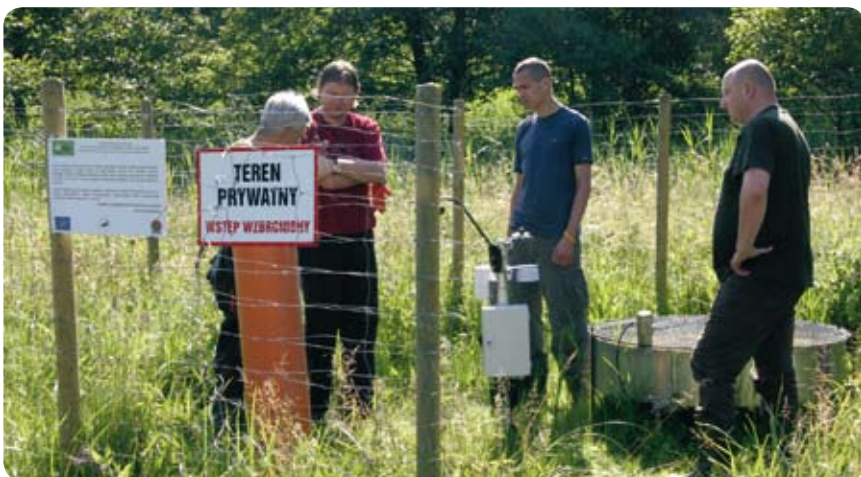
Fot. 39. Stacja meteorologiczna (rejestracja: temperatury, opadów, promieniowania, wilgotności gleby, siły i kierunku wiatru, ewapotranspiracji) ze sprzężonym pomiarem poziomu wód gruntowych i tempem pionowego przepływu wody (za pośrednictwem znajdującego się w gruncie lizymetru), monitorująca warunki hydrologiczne torfowiska alkalicznego Fot. D. Horabik
