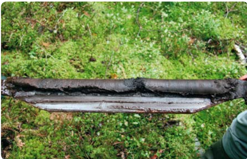
Fot. 32. Wydobyty za pomocą specjalnego świdra profil torfu umożliwia odczytanie historii torfowiska i sposobu jego zasilania w wodę, a wiedza ta jest kluczowa dla prawidłowego zaplanowania ochrony
