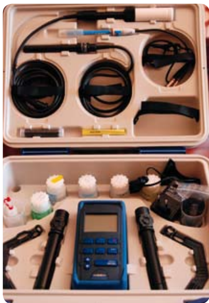
Fot. 38. Przenośny miernik umożliwiający pomiary nie tylko pH, EC, temperatury wody czy zawartości tlenu. Po zastosowaniu dodatkowych elektrod można nim mierzyć również wartość jonów wielu pierwiastków
